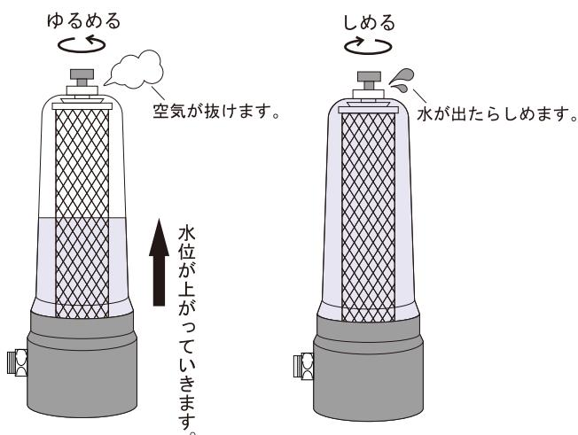
3. 切替コックのハンドルを浄水にして、水を出します。
